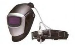
>> El sistema Speedglas Fresh-air (aire comprimido) proporciona un factor de **protección respiratoria 200**, por lo que es una alternativa excelente para entornos con altos niveles de humos y gases con partículas. Con la válvula reguladora ligera montada en el cinturón, los soldadores pueden ajustar el caudal de aire entre 140 y 300 litros por minuto y, por consiguiente, la válula es **idónea para trabajos a temperaturas muy altas o arduos.**
